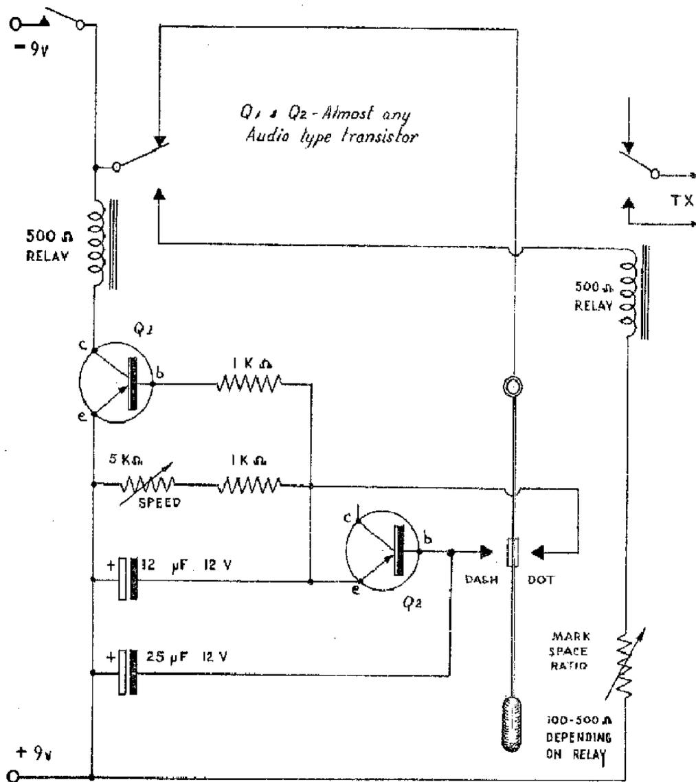
*FIG 1. SIMPLE ELECTRONIC KEYS.*
