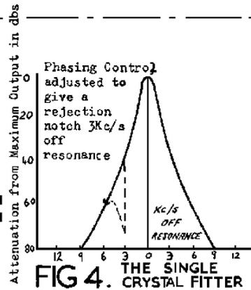
FIG 4. THE SINGLE CRYSTAL FILTER
