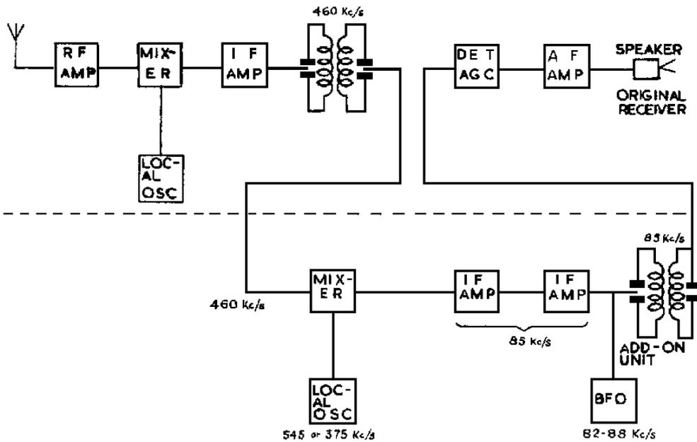
FIG 3. THE Q 5 ER PRINCIPLE
